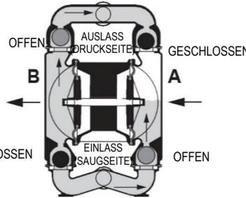
**ABBILDUNG 2** Wenn die mit Druck beaufschlagte Membran A die Grenze ihres Förderhubs erreicht, leitet das Luftventil die Druckluft auf die Rückseite der Membran B. Die Druckluft drückt die Membran B von der Mitte weg und zieht dabei die Membran A zur Mitte.
