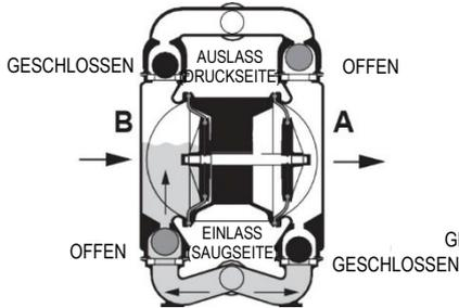
**ABBILDUNG 1** Das Luftventil leitet Druckluft auf die Rückseite der Membran A. Die Druckluft wird direkt auf die durch Elastomermembranen getrennte Flüssigkeitssäule geleitet. Die Membran wirkt als Trennmembran zwischen der Druckluft und der Flüssigkeit, wobei die Last ausgeglichen und die mechanische Belastung von der Membran genommen wird. Die Druckluft bewegt die Membran von der Mitte der Pumpe weg.
