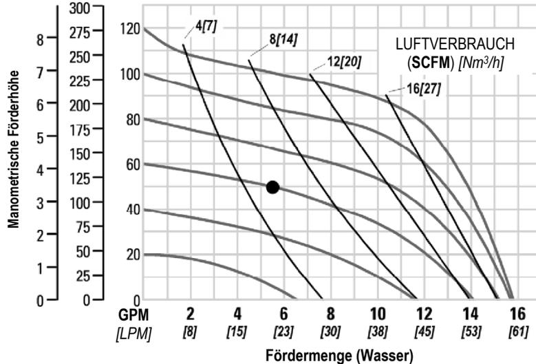
Die in der Tabelle angegebenen Fördermengen wurden mit Wasser als Pumpmedium ermittelt. Um eine optimale Lebensdauer und Leistung zu erreichen, sollten die Pumpen so ausgelegt werden, dass die täglichen Betriebsparameter in der Mitte der Pumpenkennlinie liegen.
