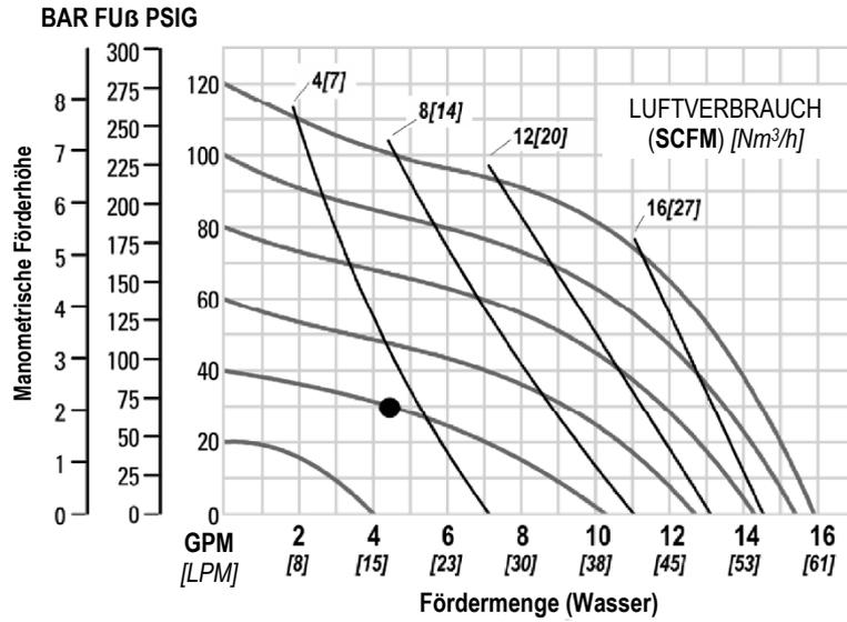
**Beispiel:** Um 17,4 l/min (4.6 gpm) gegen eine manometrische Förderhöhe von 2,1 bar (30 psig) zu pumpen, sind 2,8 bar (40 psig) und 5,9 Nm<sup>3</sup>/h (3.5 scfm) Druckluft erforderlich.
