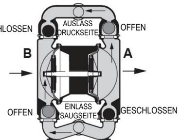
**ABBILDUNG 3** Nach Beendigung des Hubs leitet das Steuerventil erneut Luft auf die Rückseite der Membran A, wodurch die Membran B ihren Förderhub beginnt. Wenn die Pumpe wieder ihren ursprünglichen Startpunkt erreicht, hat jede Membran eine Entlüftung und einen Förderhub ausgeführt. Die beschriebenen Schritte entsprechen einem vollständigen Pumpzyklus. Je nach den Bedingungen kann es mehrere Zyklen dauern, bis die Pumpe vollständig entlüftet ist.
